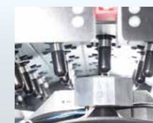
Přesné dávkování díky speciálně vyvinutým magnetickým ventilům
